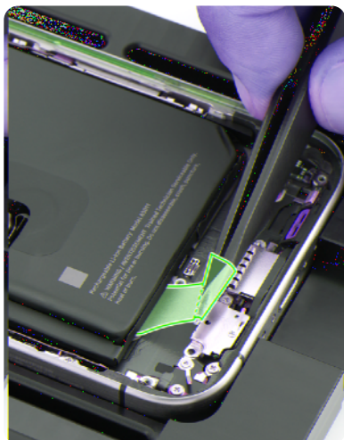
Az iPhone-akkumulátorok olyan speciális ragasztókkal vannak rögzítve, amelyek kialakításuknak köszönhetően felengednek, ha egy adott irányba mozgatják őket, ami lehetővé teszi a cserét.
