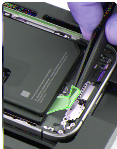
iPhone-batterier säkras med hjälp av avancerade lim som är designade för att släppa när de sträcks i en viss riktning, vilket möjliggör batteribyte.
