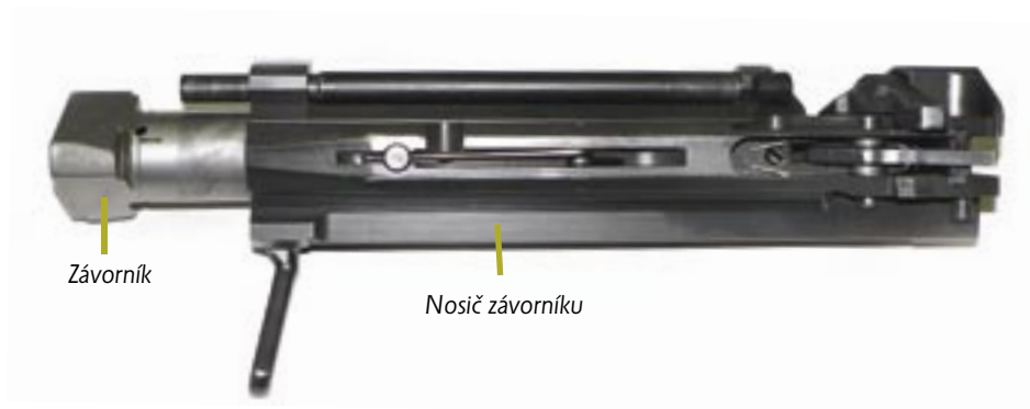
Detail závěru 12,7mm odstřelovačské pušky Barrett M82A1
