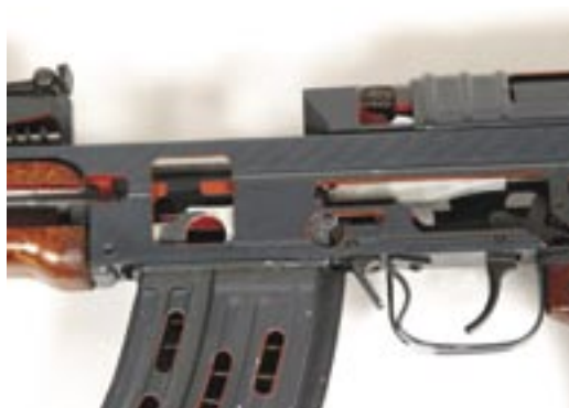
Poloha součástek závěru v době, kdy je závěr v zadní poloze
