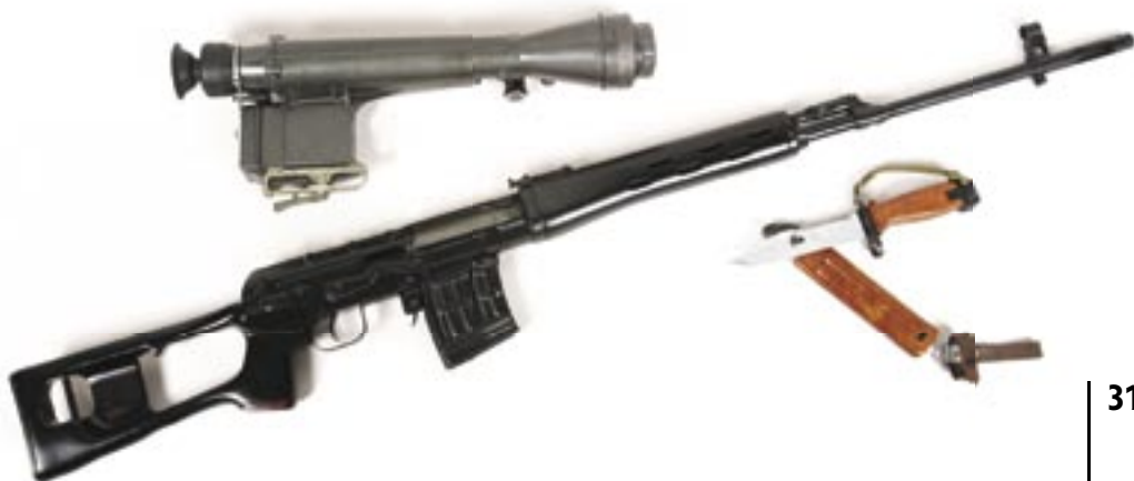
7,62mm odstřelovačská puška Dragunov N s nočním optickým zaměřovačem NSPU (v současnosti je nahrazen nočním zaměřovačem MEO 50 M)
