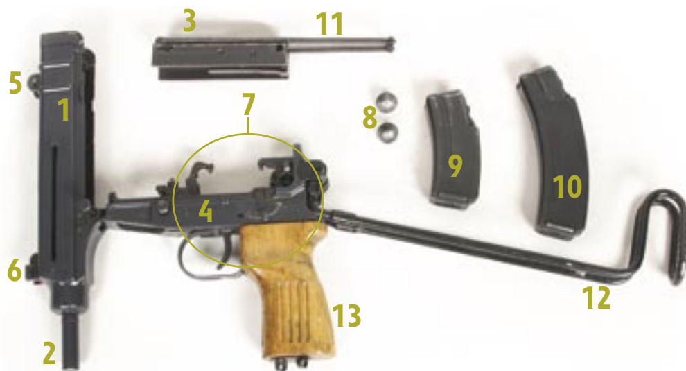
7,65mm samopal vzor 61 Škorpion rozebraný k čištění
