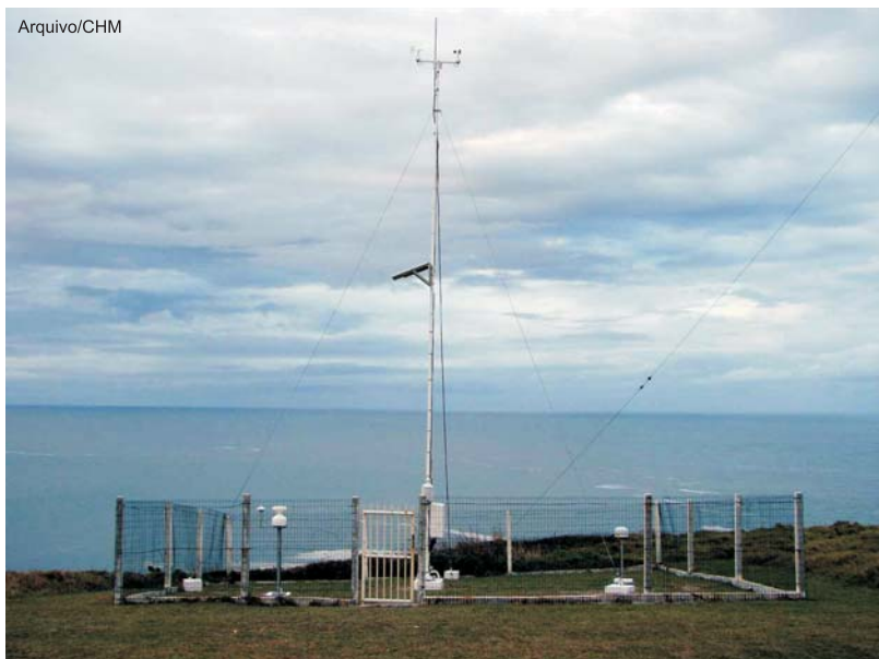
Estação meteorológica automática em Santa Marta.
