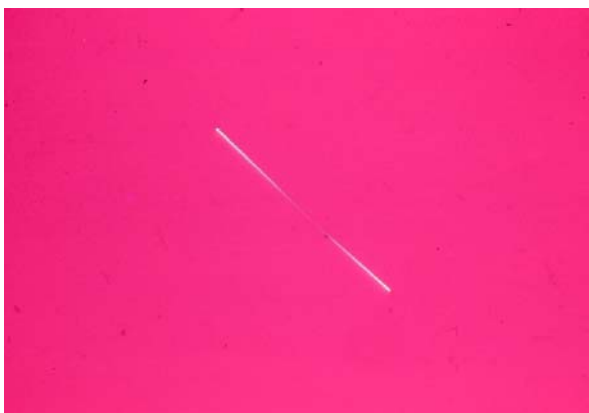
Jy30-284 Même champ. Microscope polarisant et filtre rouge de premier ordre. La partie centrale est trop mince pour avoir une biréfringence marquée.
