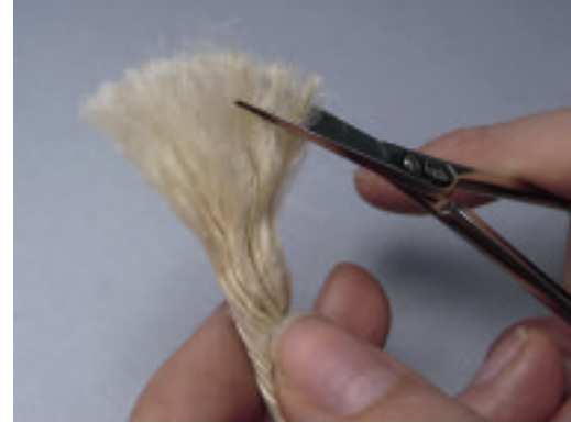
1 | Für die Herstellung einer Kittmasse aus Hanffasern wird eine Hanfkordel aufgefasernt und in ein Millimeter lange Fasern geschnitten.
