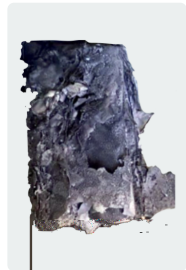
Batterie eines Drittanbieters nach einem Test auf missbräuchliche Überladung, der das Laden der Batterie über die vorgesehenen Grenzen hinaus simulieren soll.
