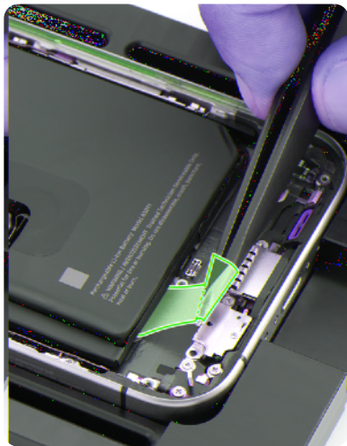
Baterije iPhone uređaja učvršćuju se pomoću naprednih ljepljiva koja su dizajnirana za otpuštanje u određenom smjeru, što omogućuje zamjenu baterije.
