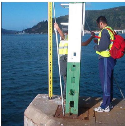
Nivelación de Mareógrafo en Ferrol
