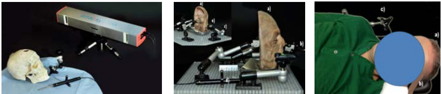
Abbildung 1: Das für die Messungen verwendeten Setups mit Tracker, linkes Bild. Mitte: Fixierung des anatomischen Präparates mit hydraulischen Armen (detto für Plastikschrädel) und Tape-Fixierung des Freiwilligen.
