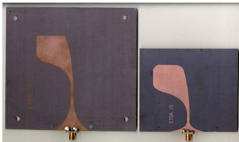
Figure 27 : Formes géométriques des antennes initiales (à gauche) et optimisées (à droite)
