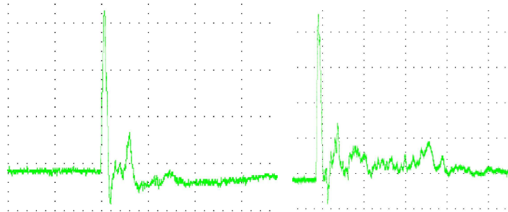
Figure 80 : Résultat de différents impacts à l'aide du banc d'essais A gauche, impact à 4,5 m/s d'une goutte de 3 mm de diamètre => 17,2 V A droite, impact à 3,2 m/s d'une goutte de 1,6 mm de diamètre => 4,68 V
