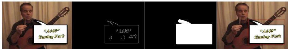
(a) Input image (b) Edge image (c) Dilation image (d) Detected region
