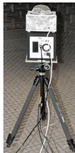
Abbildung 5: Funkengenerator und Lautsprecher auf Stativ, Foto: GFaI e.V.
